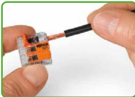
Leiter anschließen: Klemmstelle durch Betätigungshebel öffnen und Leiter einführen.
